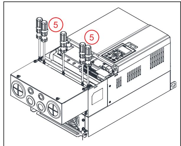
**Frame E Conduit Box Installation**
