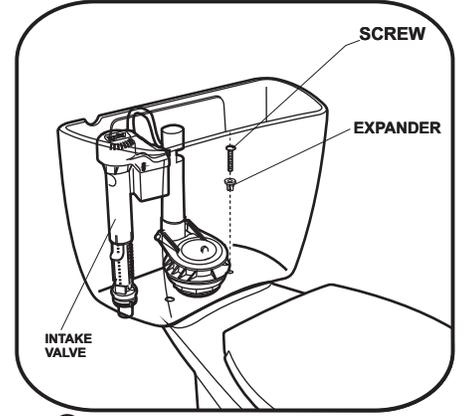
**4** TIGHTEN SCREWS ALONG WITH EXPANDERS INTO TANK; SIT TANK ON BOWL.
