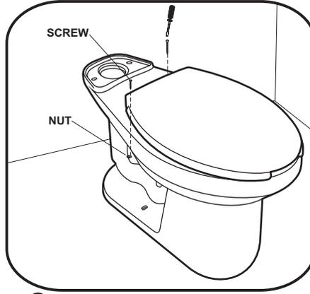
**3** PLACE TOILET SEAT; INSERT SCREWS IN THE HOLES ON SEAT'S RIM; TIGHTEN SCREWS UNTIL IT IS WELL SECURED.
