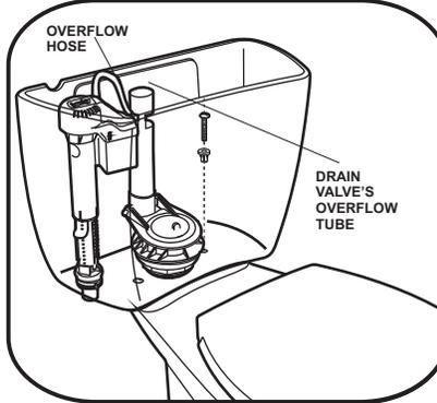
**6** TAKE OVERFLOW HOSE, INSERT ONE END ON THE INTAKE VALVE TUBE AND THE OTHER END ON THE DRAIN VALVE'S OVERFLOW TUBE.
