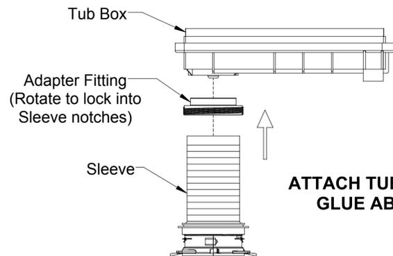
**ATTACH TUB BOX ADAPTER TO SLEEVE.
