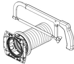
**CUT INNER SLEEVE TO DESIRED HEIGHT. (IF NEEDED)
