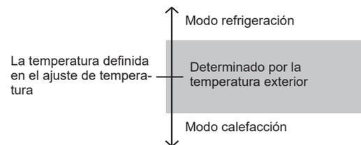
Al seleccionar Auto mode (modo automático) por primera vez, el ventilador funcionará a velocidad muy baja durante unos minutos, mientras la unidad interior determina las condiciones de la habitación y selecciona el modo de funcionamiento adecuado.
