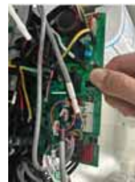
6. Retirez la carte de circuit imprimé et débranchez le capteur de fuite de réfrigérant du connecteur CN3.
