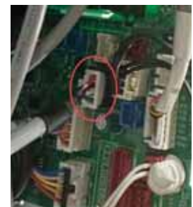
4. Retirez la carte de circuit imprimé et débranchez le capteur de fuite de réfrigérant du connecteur CN3.
