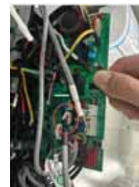
6. Retire la placa del circuito impreso (PCB) y desenchufe el sensor de pérdida de refrigerante del CN3.
