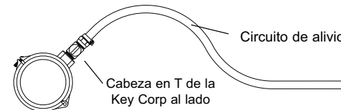
Instalación recomendada de Abrazadera, Válvula de Inserción y Línea de Servicio.
