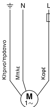
Σχ. 9 2σύρματοι κινητήρες
