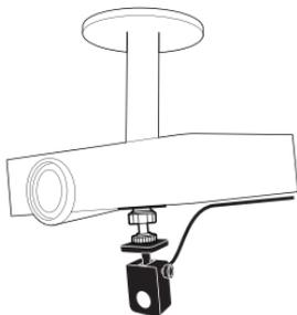
注意：倒懸的固定座上的強力黏膠只能使用一次，黏貼前請再三確認安裝位置正確。但感測器可自懸掛固定座上旋下單獨使用，無需拆下底座。
