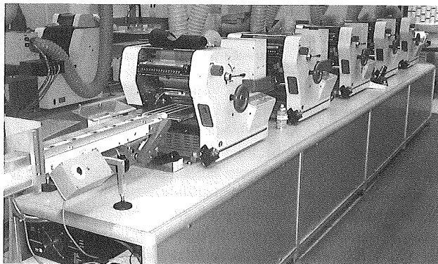
Bild 10.28 Hintereinander angeordnete Serie von fünf Einzelkartendruckmaschinen für den Siebdruck auf einzelne Karten.
