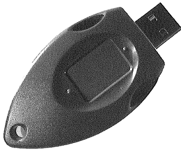
Bild 8.8 Foto eines USB-Tokens mit integriertem Fingerabdrucksensor und Chipkarten-Mikrocontroller. (Giesecke & Devrient).
