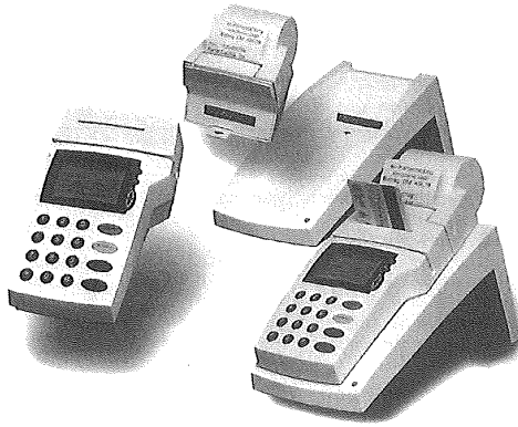
Bild 11.3 Beispiel für ein tragbares Chipkarten-Terminal für den elektronischen Zahlungsverkehr mit Kreditkarten, Debitkarten und elektronischen Geldbörsen. Das Terminal besitzt ein integriertes Sicherheitsmodul, einen Drucker und ist Offline-fähig. (Giesecke & Devrient – ZVT 900)
