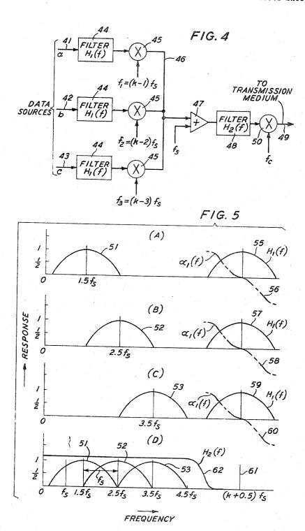
ORTHOGONAL FREQUENCY MULTPLEX DATA TRANSMISSION SYSTEM
