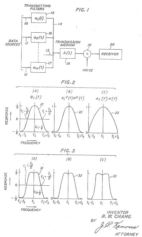
ORTHOGONAL FREQUENCY MULTPLEX DATA TRANSMISSION SYSTEM
