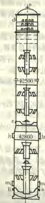
图 7-11 自然循环外冷式碳化塔 a—出碱口; b—下段气入口; c—中段气入口; d—氨母液入口; e—尾气出口; j—外循环出口; m1, 2—外循环入口
